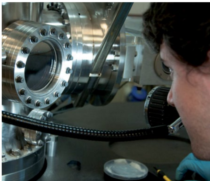
INSTALADO NO LABORATÓRIO DE ENGENHARIA DE SUPERFÍCIES, O EQUIPAMENTO DE ESPECTROSCOPIA DE FOTOELÉTRONS REALIZA, COM ALTA PRECISÃO, A ANÁLISE QUÍMICA DE MATERIAIS
