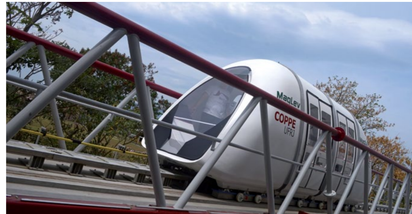
O MAGLEV-COBRA TRANSPORTARÁ ALUNOS, PROFESSORES E FUNCIONÁRIOS EM UMA LINHA EXPERIMENTAL DE 200 METROS CONSTRUÍDA PELA COPPE NA CIDADE UNIVERSITÁRIA
