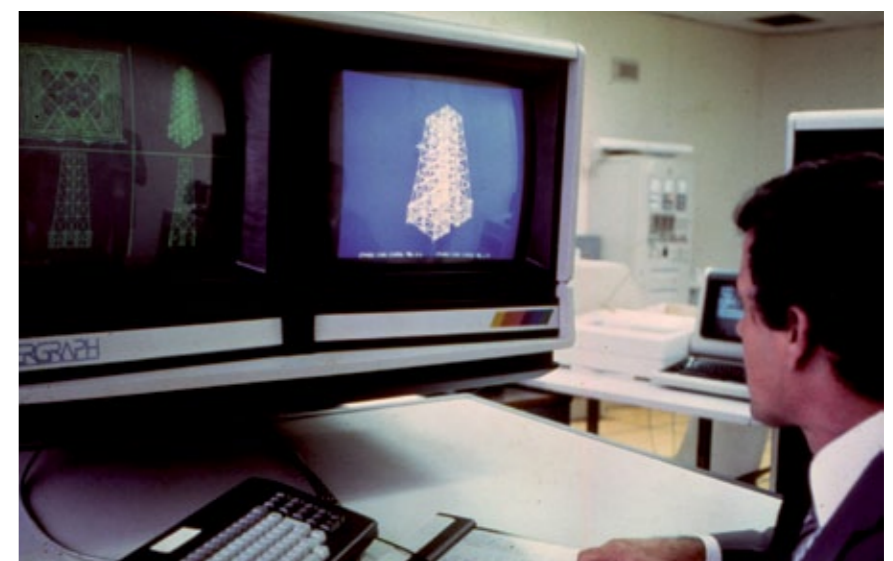
PESQUISADOR DO CENPES UTILIZA MÓDULO DE VISUALIZAÇÃO SISPLOT DOS SISTEMAS ADEP E INPLA DESENVOLVIDOS NA COPPE, EM 1977, PARA PROJETOS E INSTALAÇÕES DE PLATAFORMAS OFFSHORE
